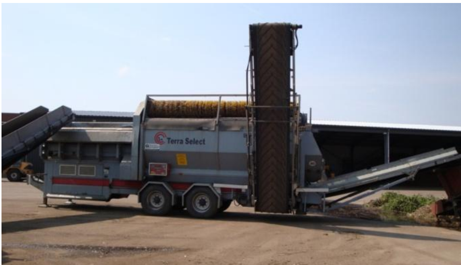
Abbildung 66: Holzhäcksler und Sortierung für den mobilen Einsatz auf dem Betriebshof von Reijnders Groenrecycling [52]
