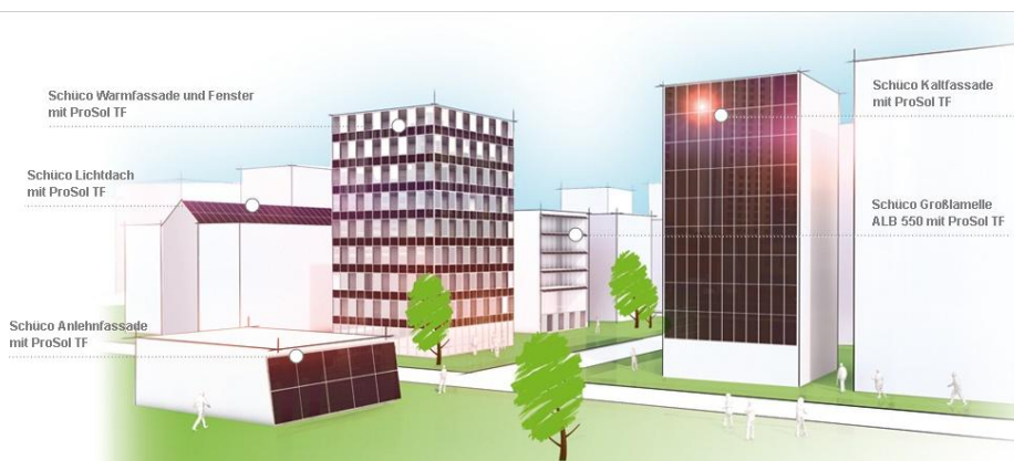
Abbildung 65: Möglichkeiten der Integration von Solarmodulen in der Gebäudehülle [51]
